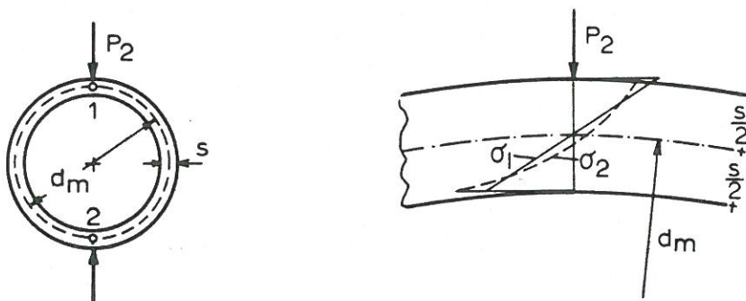
Fig. 3. Stress distribution for line load - jännityksen jakautuminen viivakuormalla ( \alpha = \beta = 0^\circ )
